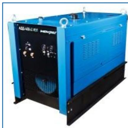
Дизельный агрегат АДД-4004ПРиУ1 используется для сварки и плазменной резки. Данная модель относится к современному оборудованию с повышенными рабочими характеристиками и рекомендована к использованию в экстремальных полевых условиях. Заказать данный агрегат вы можете на заводе электросварочного оборудования Искра.
