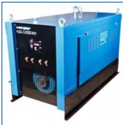
Агрегат позволяет проводить сварку электродами с любым типом покрытия, так как питание осуществляется от источника постоянного тока, которым служит генератор индукторного типа с выпрямлением тока, КПД 70 %.
